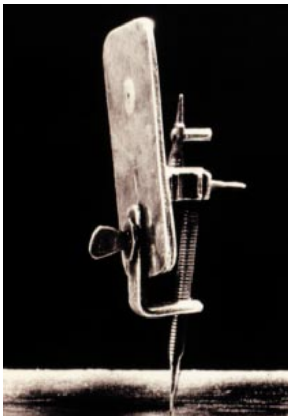
O microscópio inventado por Van Leeuwenhoek em 1677
