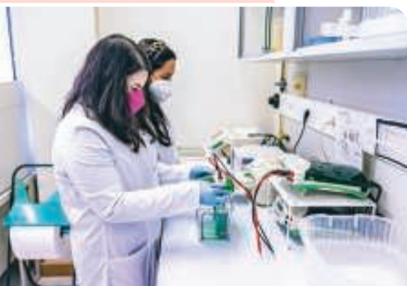
No laboratório de química geral, Inês Marques e Beatriz Serambeque preparam um sistema de Western Blotting, que permite identificar, analisar e quantificar proteínas.
